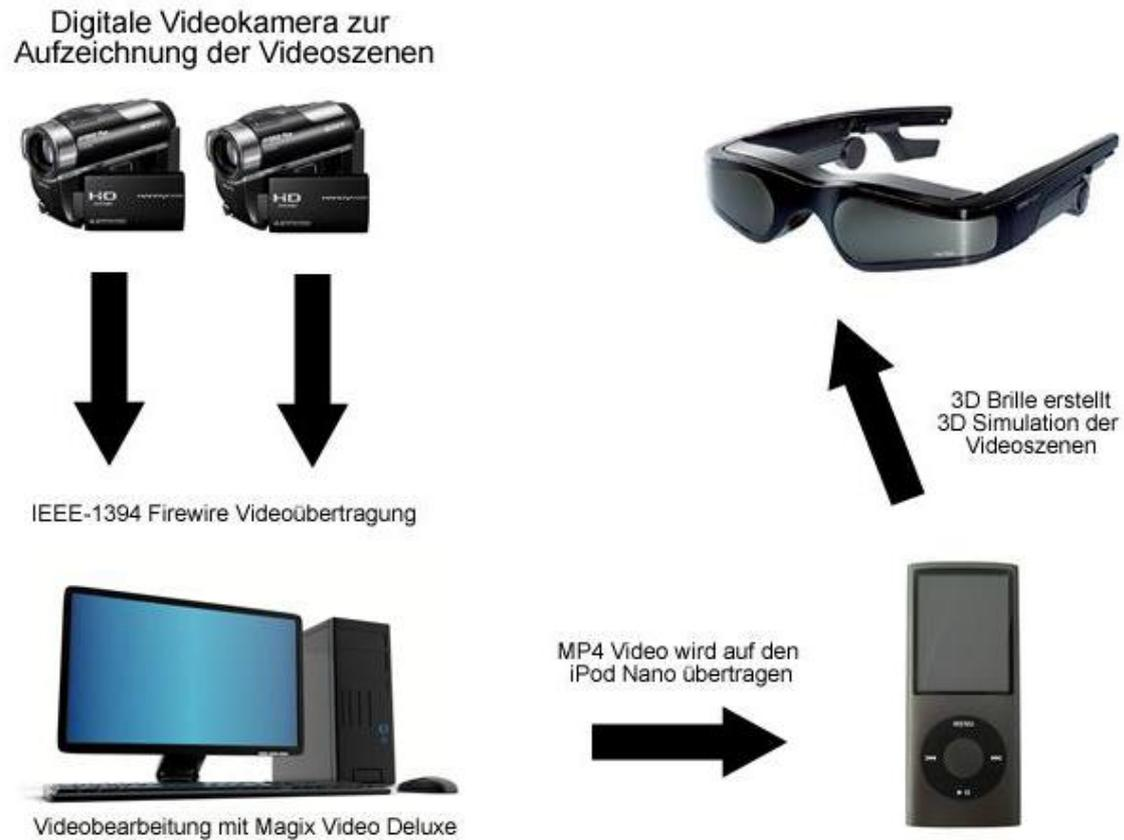
Abbildung 22 : Schematische Darstellung der Arbeitsmaterialien
