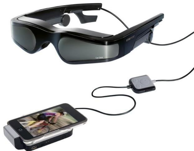
**Abbildung 24: Videobrille „Cinemizer“ mit angeschlossenenem iPod® (Zeiss, 2009)**
