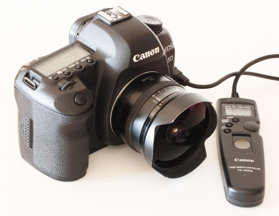
**Abbildung 53: Die verwendete Canon EOS 5D Mark2 Kamera, das Canon 2,8/15mm Fisheye-Objektiv und der Canon TC-80N3 Intervalltimer**
