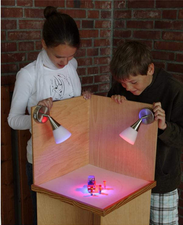
„Zwei Leuchten unterschiedlicher Farbe erzeugen verblüffende Schatten.“<sup>217</sup> Da die Schatten der einen Lichtquelle von der anderen Lichtquelle beleuchtet werden, nehmen sie dadurch die jeweils andere Farbe an, als die, die den Schatten erzeugt.
