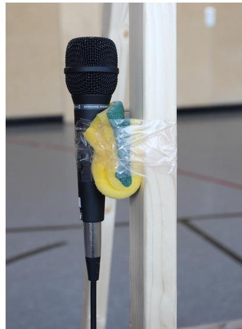
**Abbildung 59: Entkoppelte Fixierung eines externen Mikrofons an einer Station**
