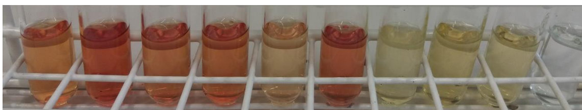
Abbildung 142: Proben 01-10 (v.l.n.r.) gemäß Tabelle 24, nach 20 Min. im Wasserbad bei 65 °C
