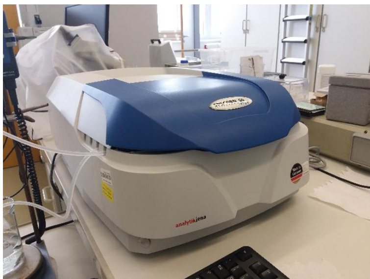
Abbildung 28: UV-Vis-Spektrometer Specord 50 plus (Analytik Jena)
