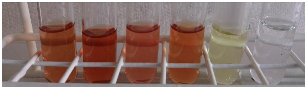
Abbildung 56: Pentylamin-Proben 21-26 v.l.n.r. nach 15 Min. im Wasserbad bei 65 °C
