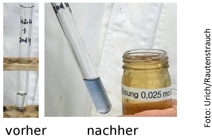
Abbildung 4: Stärkenachweis mit Iodlösung ( c = 0,025 \text{ mol/L} )
