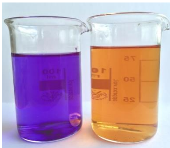
Abbildung 113: Die Darstellung der Verfärbung des Alizarin/Sauerstoff-Zelle mit einer stark verdünnten Alizarin-Lösung
