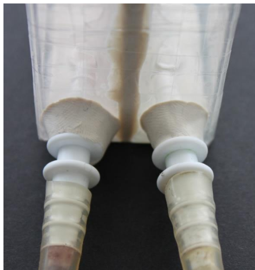
Abbildung 192: Dichtung der Ausgänge der TicTac-Dose
