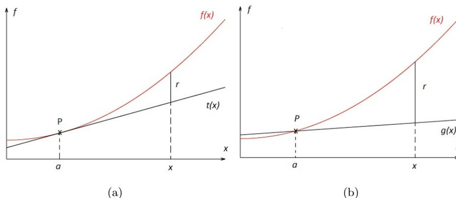
Abbildung 2.1: Lineare Approximation über (a) eine Tangente und (b) eine beliebige Gerade an den Graphen einer Funktion
