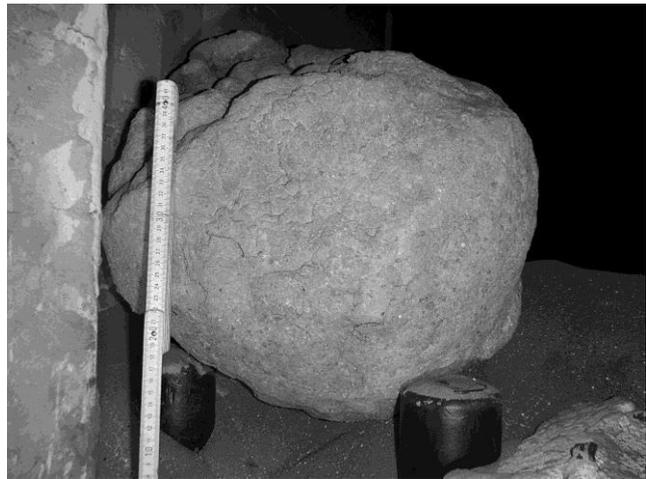
**Abb. 2.6.** Agglomerat aus gesintertem Umlaufmaterial in der Leerkammer eines Fließbettkühlers, Kessel 11 der Stadtwerke Flensburg (Aufnahme des Autors)
